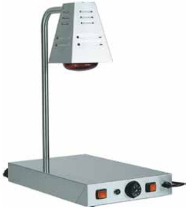
Struttura in acciaio inox. Lampada a raggi infrarossi. Termostato regolabile 0°-90°C, V230 50/60 Hz, W 250+250.
