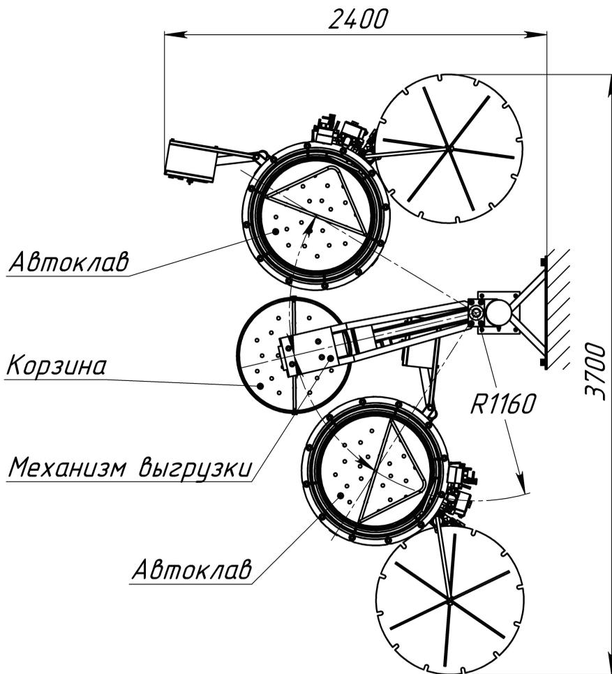
Рисунок 2. Автоклав ИПКС-128-500МВ (механизм выгрузки корзин).
