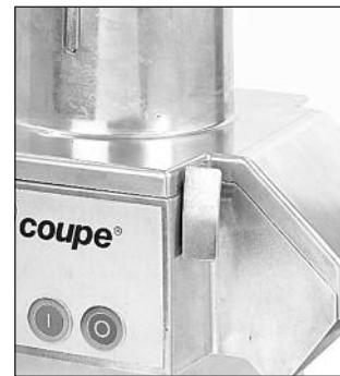
Поднимите воронку, наклонив ее назад, чтобы высвободить рабочий отсек.
