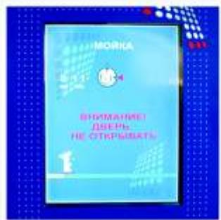
Еще одним достоинством пароконвектоматов является полностью автоматическая мойка с тремя режимами работы: быстрая, полная и средняя. Теперь повару не надо отвлекаться на мойку камеры пароконвектомата после окончания готовки. Аппарат автоматически будет добавлять в камеру моющие и ополаскивающие средства в требуемых объемах.
