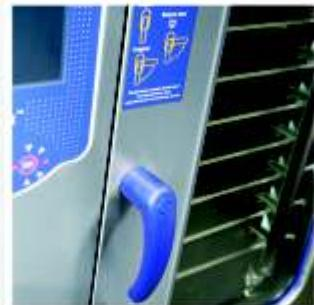
Пароконвектомат оснащен дверью с двойным термостойким остеклением, при этом, внутреннее стекло, дополнительно, сберегает тепловую энергию за счет своих теплоотражающих свойств. Открывающееся внутреннее стекло позволяет полностью мыть стекла с двух сторон, а также предотвращает образование конденсата при приготовлении.
